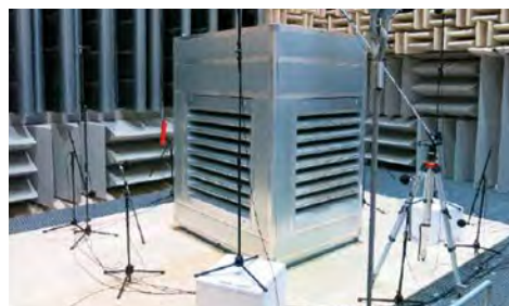
Schalldämmgehäuse SDG23 + STANDARD 100 mm mit schallgedämpfter Kondensatwanne und Deflektor saugseitig
