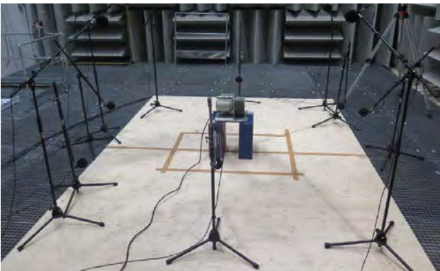
Aufbau der Referenzschallquelle, Schalleistungsmessung ohne SDG10 (MP1)
