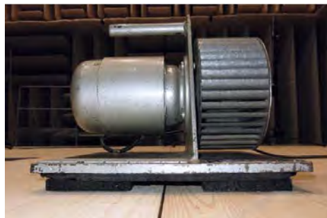
Aufbau der Referenzschallquelle, Schalleistungsmessung ohne SDG13.
