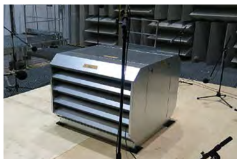
Aufbau des Schalldämmgehäuses SDG13 mit der Referenzschallquelle.
