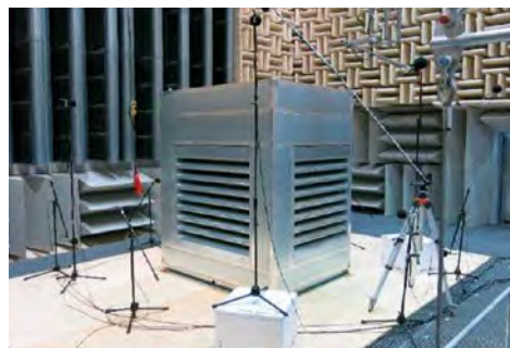
Schalldämmgehäuse SDG19 + STANDARD 50 mm mit schallge- dämpfter Kondensat- wanne und Deflektor saugseitig
