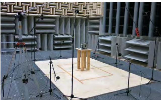
Aufbau der Referenzschallquelle, Schalleistungsmessung ohne SDG18 (MP1)
