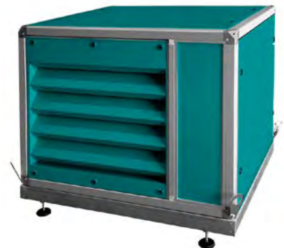
Einhausung mit horizontaler Ansaugung und Ausbläsung – Dämmung 50 mm
