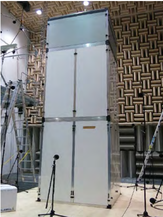
Aufbau der Schallschutzgehäuse SEH28V-100 mit der Referenzschallquelle
