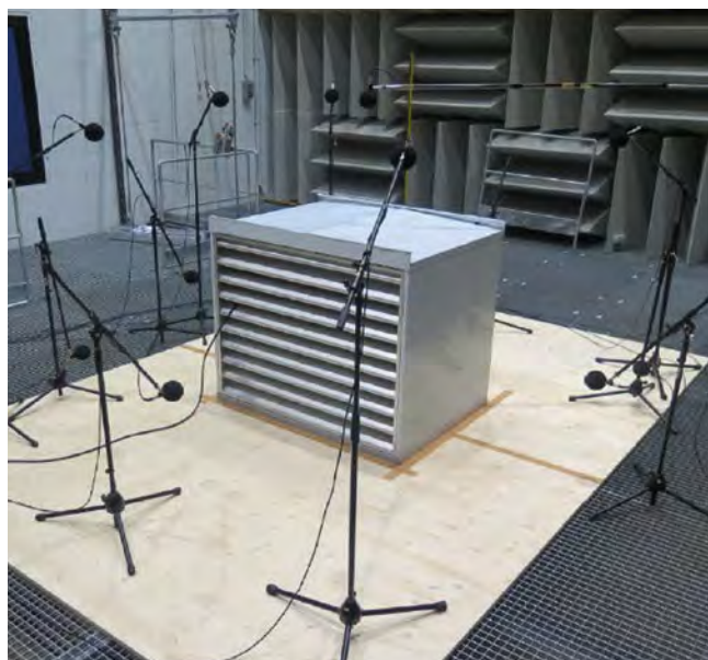
Aufbau des Schalldämmgehäuses SDG10 mit der Referenzschallquelle (MP2)
