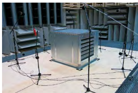
Schalldämmgehäuse SDG18H + STANDARD 50 mm mit schallge- dämpfter Kondensat- wanne und Deflektor saugseitig
