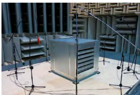
Schalldämmgehäuse SDG20 + STANDARD 100 mm mit schallgedämpfter Kondensatwanne und Deflektor saugseitig
